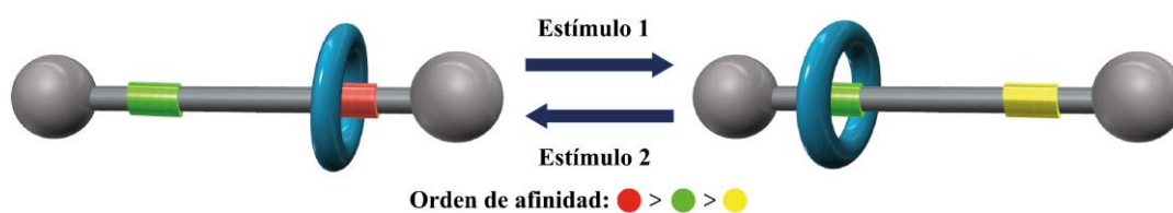
Figura 3.1. Representación esquemática del funcionamiento de una lanzadera molecular.
